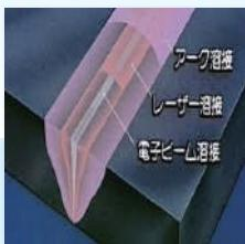
車載向けパワステ制御回路、エンジン回転数制御回路や、今後増産が見込まれるPHV向けのバッテリーユニット部分に採用されております。電子ビーム溶接は、陰極をフィラメントで加熱することによって放出される熱電子を利用して、電圧差で作った電磁場を利用して加速させ電子の運動エネルギーで加熱する溶接方法です。
